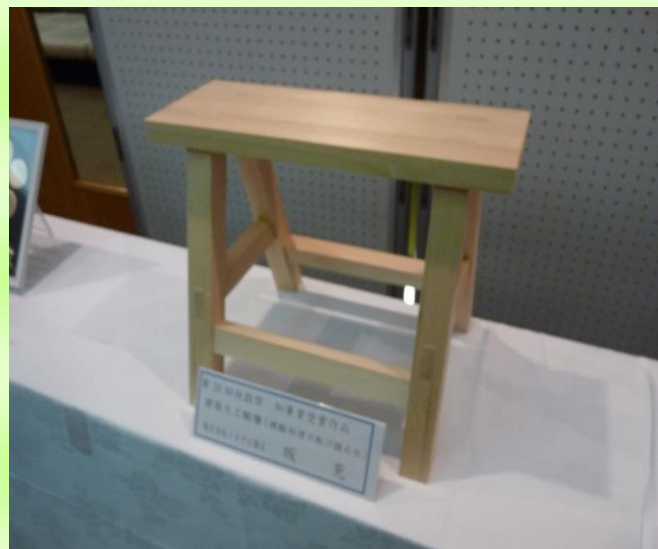
建築大工：柱建片転び踏み台
